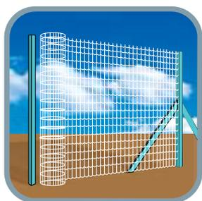
**3** Proceda a fixação da tela ao primeiro poste (esticador) utilizando-se de arame **Tellacor Morlan®**.
